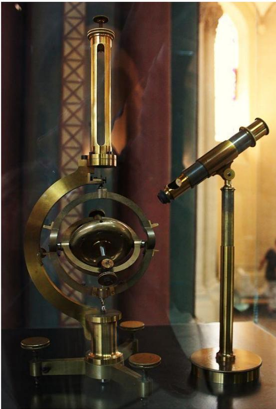
Гироскоп – прибор, имеющий свободную ось вращения и способный реагировать на изменение углов ориентации тела, на котором он установлен.
